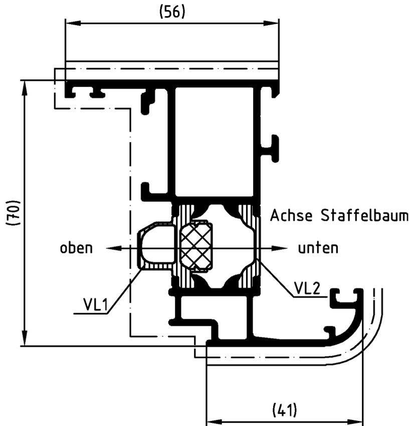
Die Profile sind generell in beiden Aluminium-Hohlkammern spannungsfrei aufzustaffeln.
