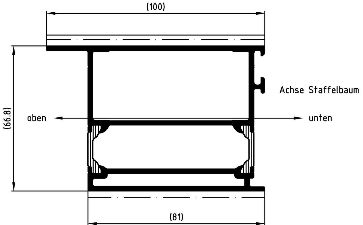
Die Profile sind generell in beiden Aluminium-Hohlkammern spannungsfrei aufzustaffeln.
