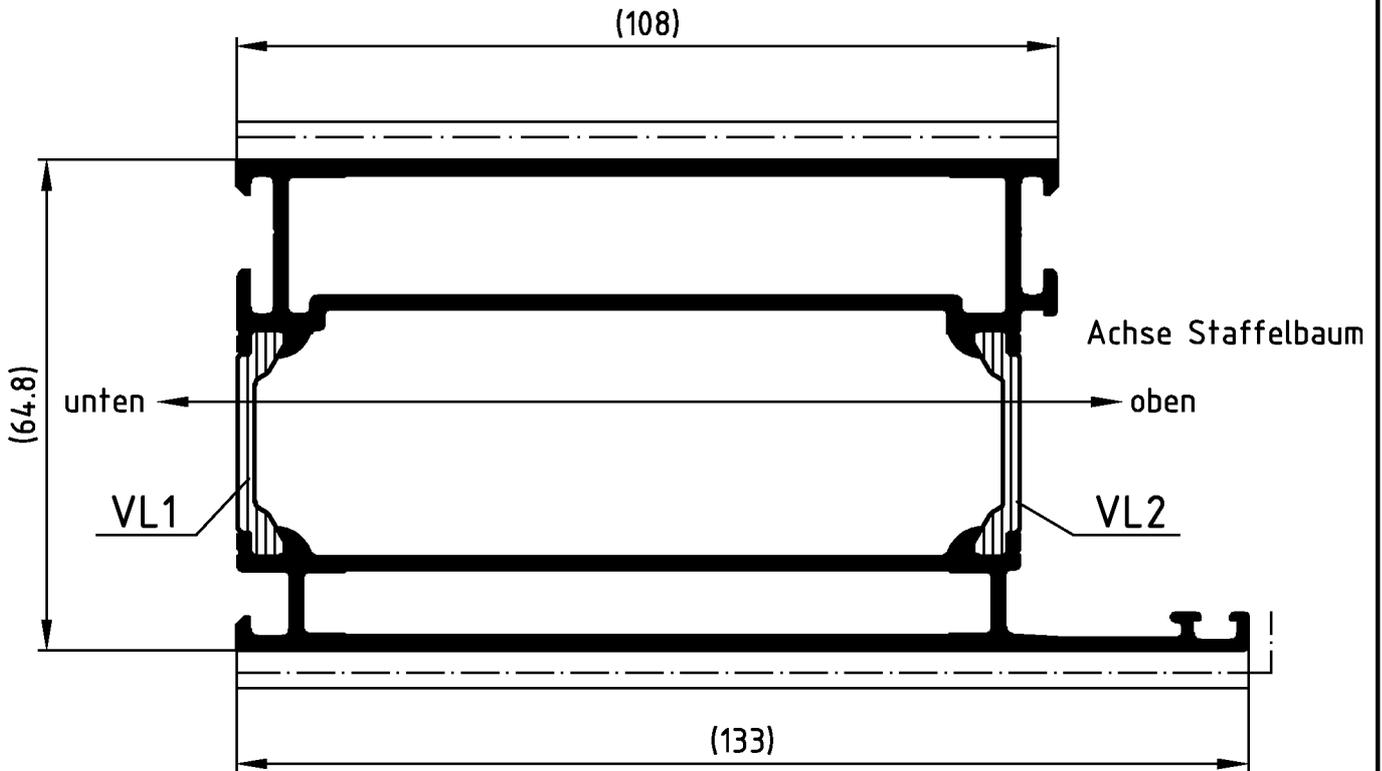
Die Profile sind generell in beiden Aluminium-Hohlkammern spannungsfrei aufzustaffeln.
