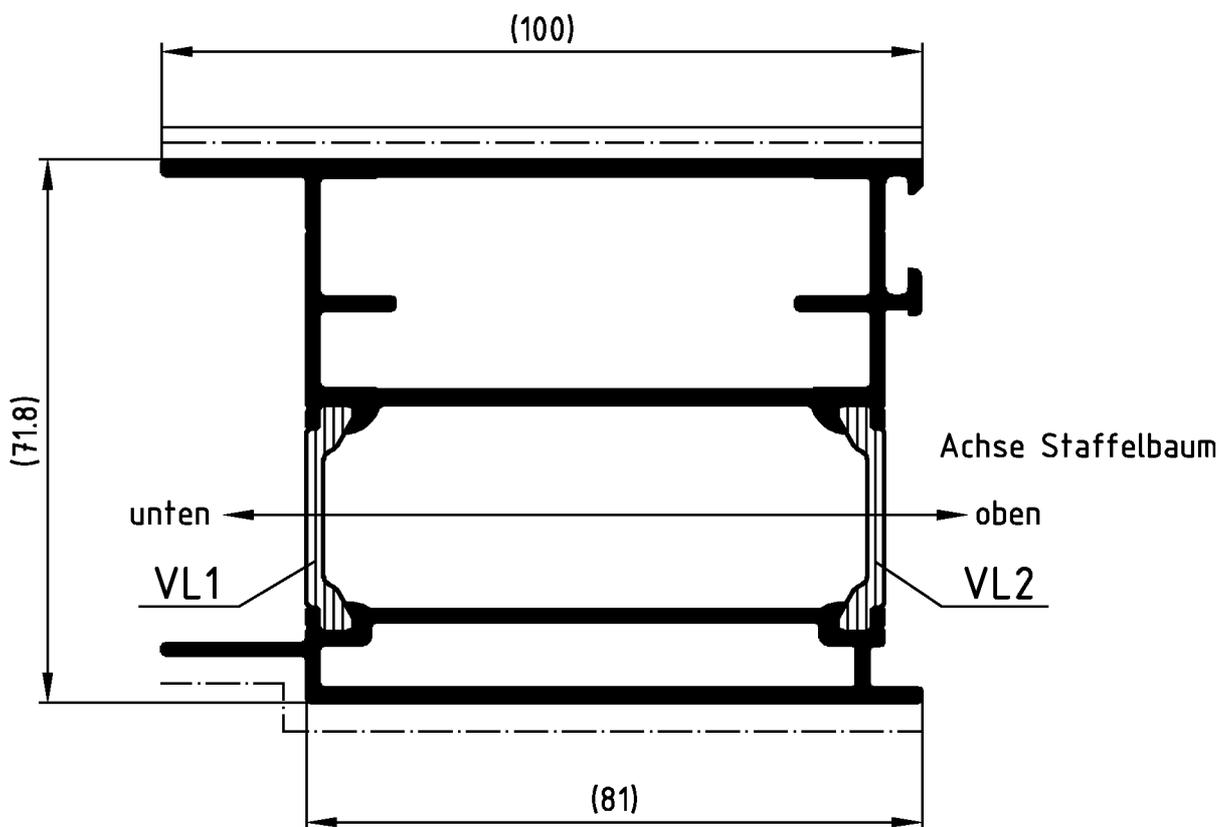
Profile vorzugsweise in einer Vertikalanlage beschichten
