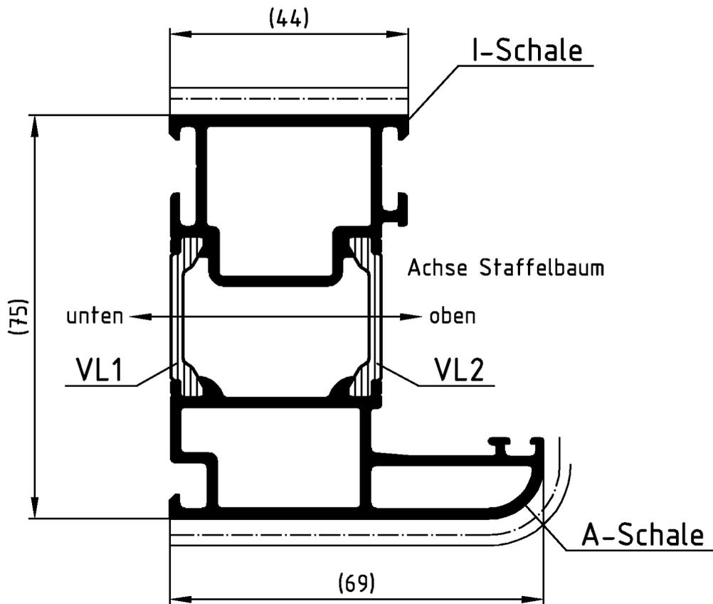
Die Profile sind generell in beiden Aluminium-Hohlkammern spannungsfrei aufzustaffeln.
