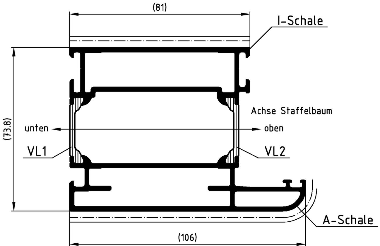
Die Profile sind generell in beiden Aluminium-Hohlkammern spannungsfrei aufzustaffeln.
