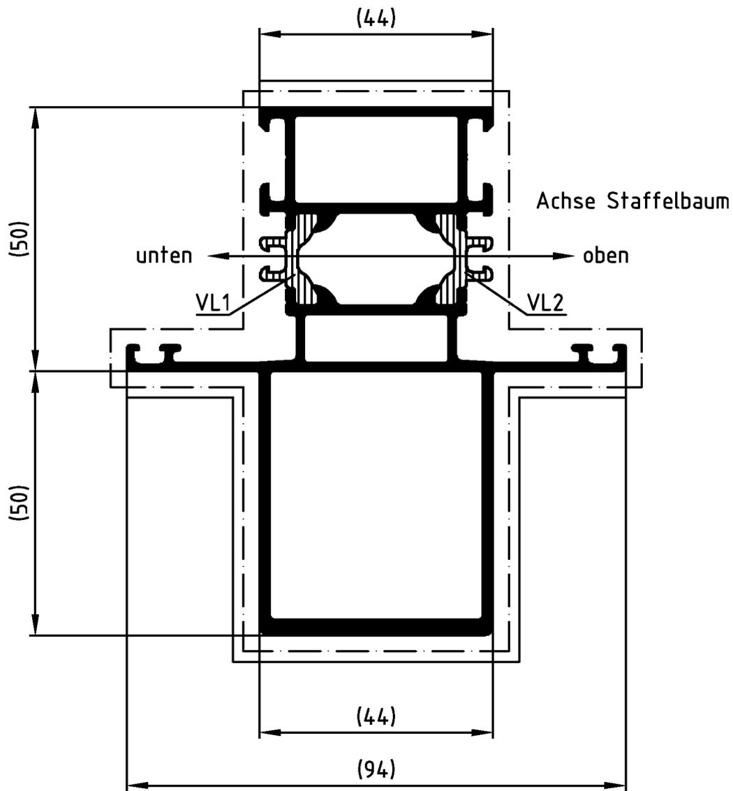
Die Profile sind generell in beiden Aluminium-Hohlkammern spannungsfrei aufzustaffeln.
