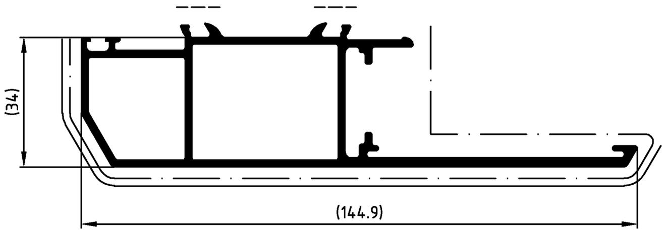
**ACHTUNG:** Nutenbereich (----) von Farbe, insbesondere von Farbspritzern und Verdickungen freihalten. Nicht vermeidbarer Lackauftrag im Nutenbereich maximal 20 µm.
