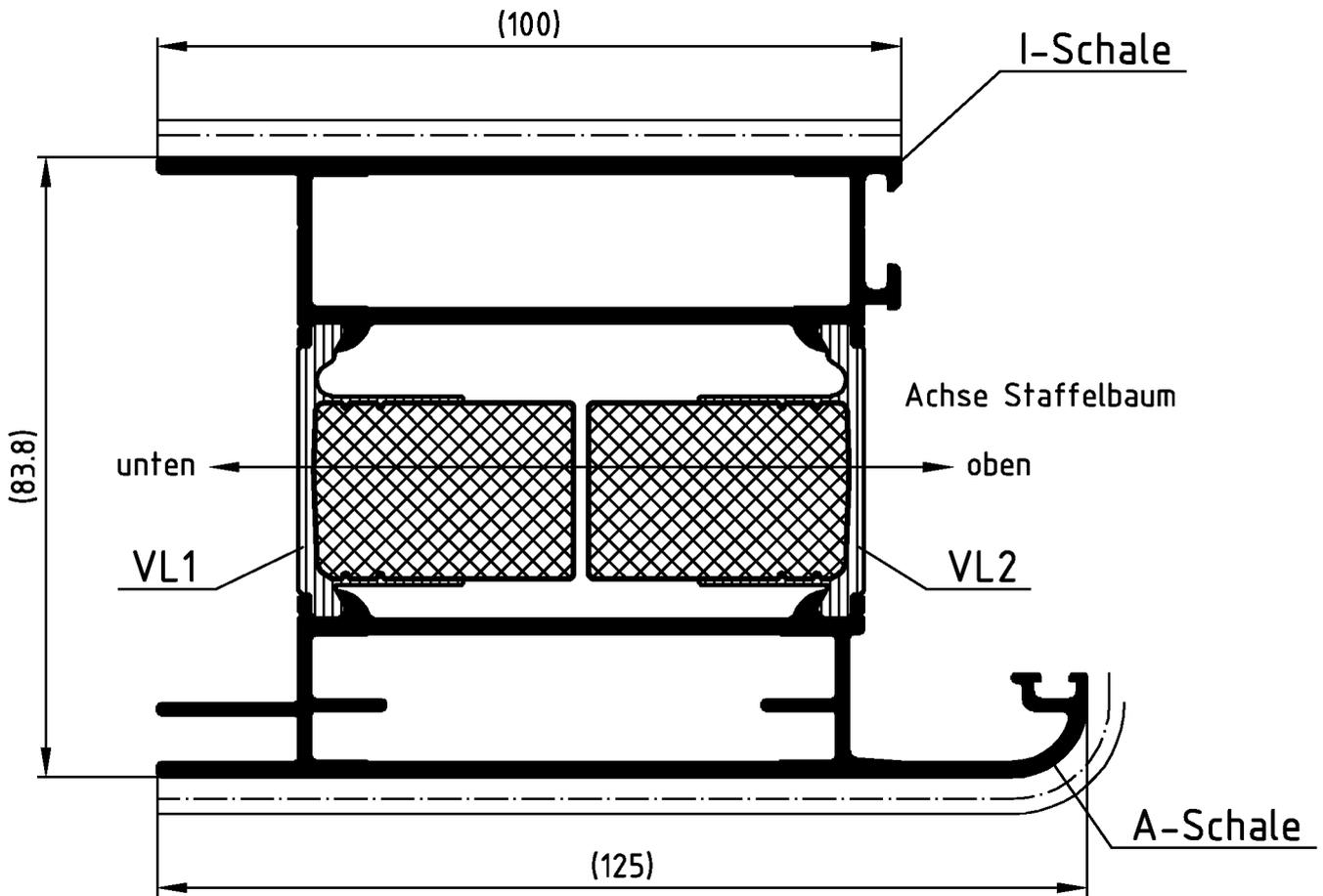
Profile vorzugsweise in einer Vertikalanlage beschichten
