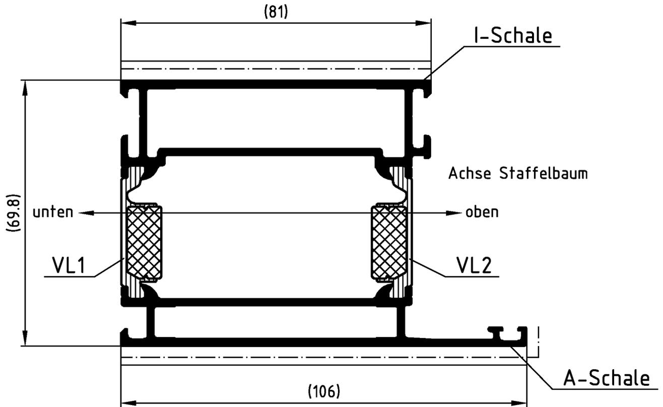
Profile vorzugsweise in einer Vertikalanlage beschichten
