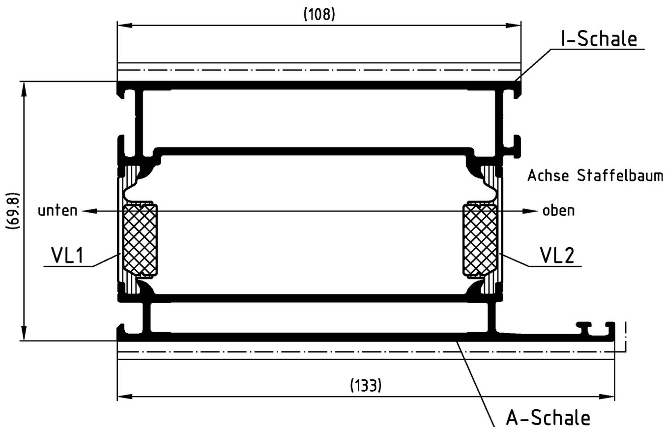
Profile vorzugsweise in einer Vertikalanlage beschichten
