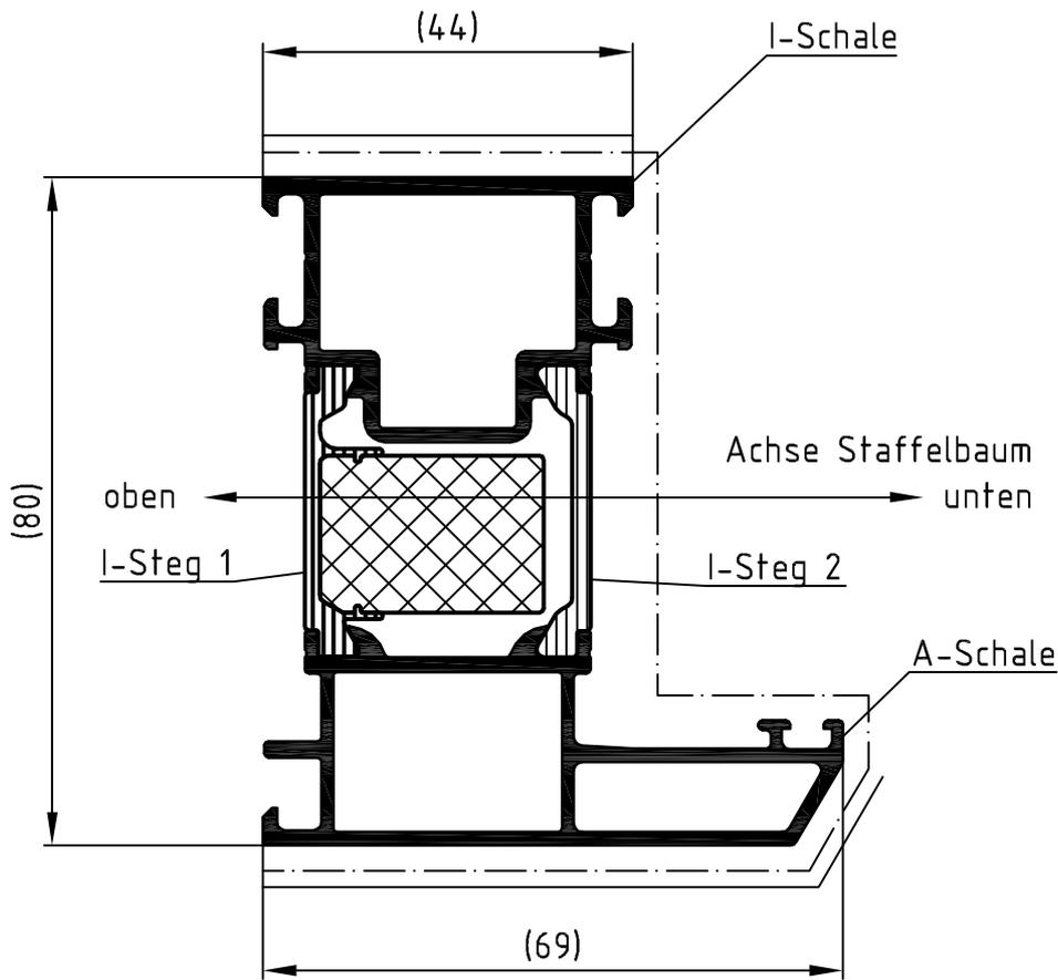
Die Profile sind generell in beiden Aluminium-Hohlkammern spannungsfrei aufzustaffeln.
