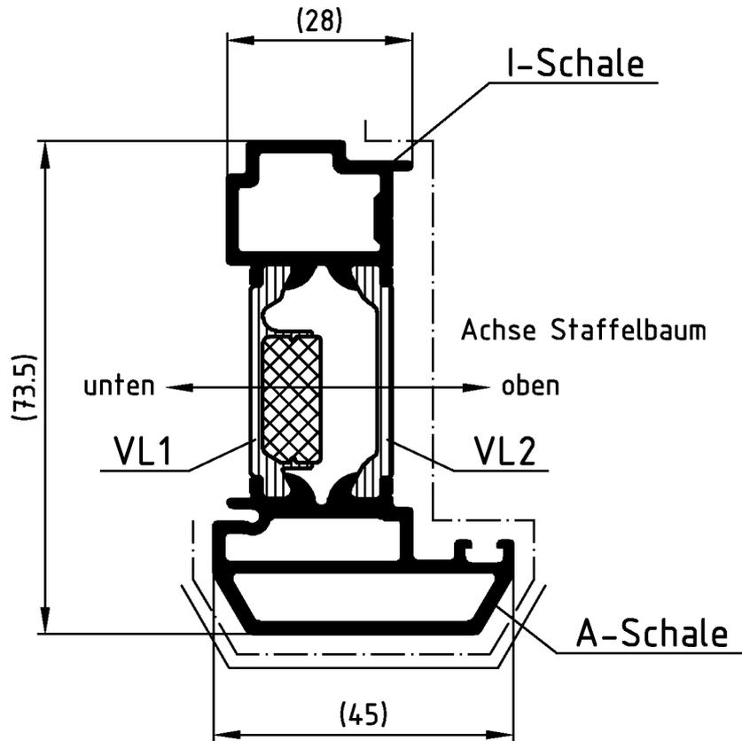
Die Profile sind generell in beiden Aluminium-Hohlkammern spannungsfrei aufzustaffeln.
