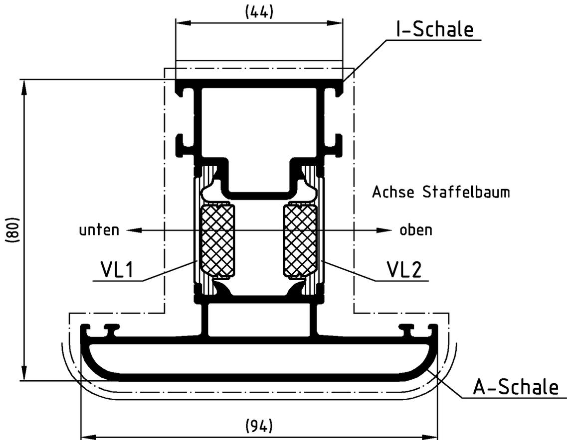
Die Profile sind generell in beiden Aluminium-Hohlkammern spannungsfrei aufzustaffeln.
