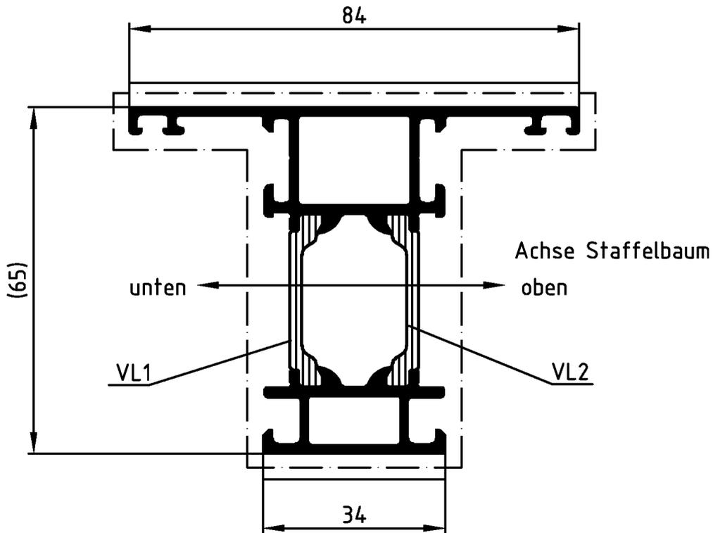
Die Profile sind generell in beiden Aluminium-Hohlkammern spannungsfrei aufzustaffeln.
