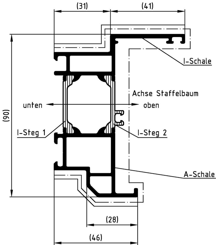
Die Profile sind generell in beiden Aluminium-Hohlkammern spannungsfrei aufzustaffeln.
