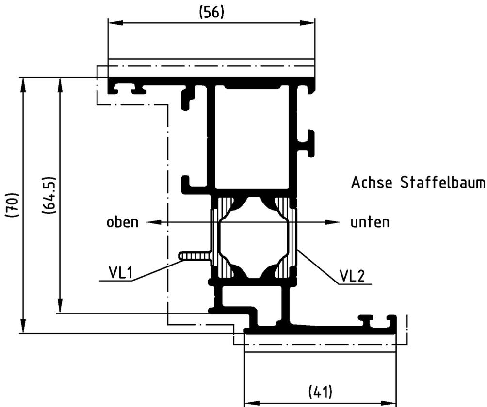
Die Profile sind generell in beiden Aluminium-Hohlkammern spannungsfrei aufzustaffeln.
