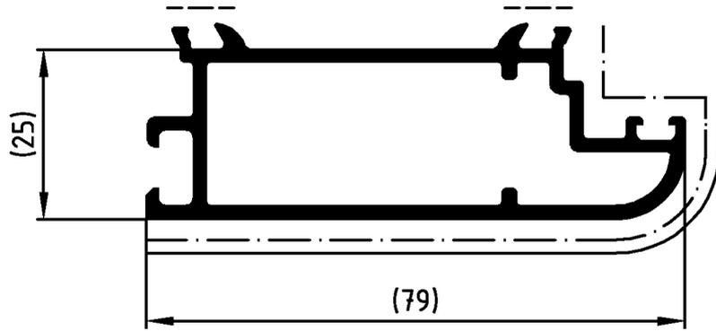
**ACHTUNG:** Nutenbereich (----) von Farbe, insbesondere von Farbspritzern und Verdickungen freihalten. Nicht vermeidbarer Lackauftrag im Nutenbereich maximal 20 µm.
