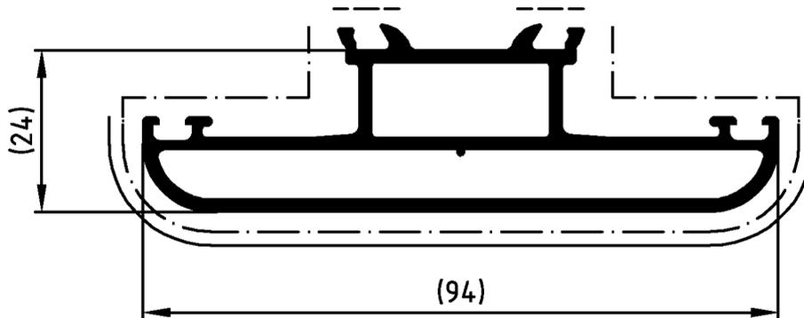
**ACHTUNG:** Nutenbereich (----) von Farbe, insbesondere von Farbspritzern und Verdickungen freihalten. Nicht vermeidbarer Lackauftrag im Nutenbereich maximal 20 µm.
