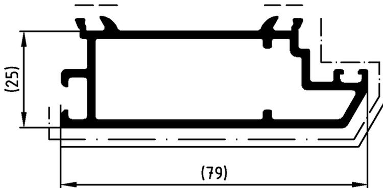
**ACHTUNG:** Nutenbereich (----) von Farbe, insbesondere von Farbspritzern und Verdickungen freihalten. Nicht vermeidbarer Lackauftrag im Nutenbereich maximal 20 µm.
