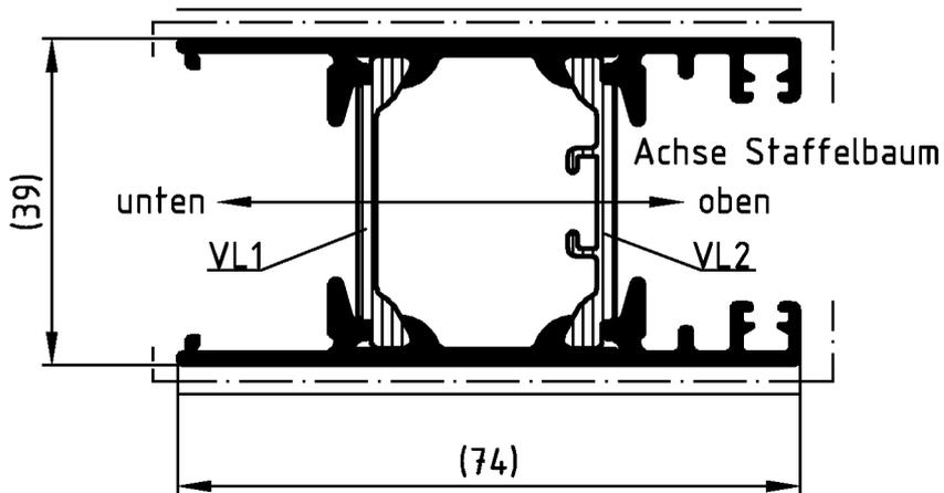
Die Profile sind generell in beiden Aluminium-Hohlkammern spannungsfrei aufzustaffeln.
