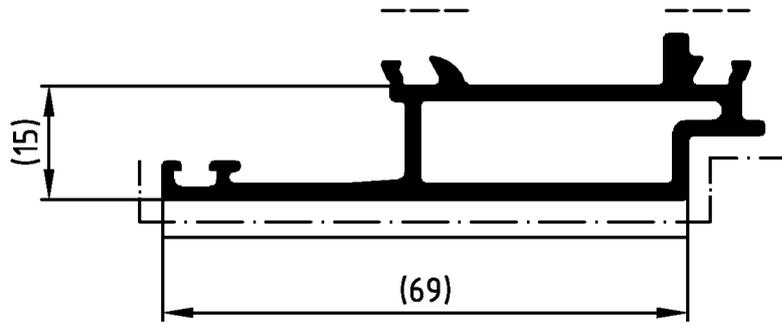
**ACHTUNG:** Nutenbereich (----) von Farbe, insbesondere von Farbspritzern und Verdickungen freihalten. Nicht vermeidbarer Lackauftrag im Nutenbereich maximal 20 µm.
