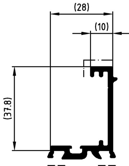
**ACHTUNG:** Nutenbereich (----) von Farbe, insbesondere von Farbspritzern und Verdickungen freihalten. Nicht vermeidbarer Lackauftrag im Nutenbereich maximal 20 µm.
