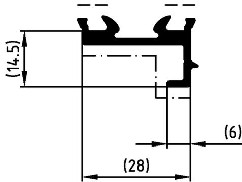
**ACHTUNG:** Nutenbereich (----) von Farbe, insbesondere von Farbspritzern und Verdickungen freihalten. Nicht vermeidbarer Lackauftrag im Nutenbereich maximal 20µm.
