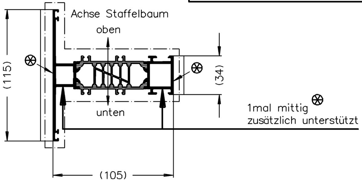
⊗ Durch ausreichenden Abstand der Profil-Sichtflächen zum mittleren Staffelbaum ist die geforderte Mindest-Schichtdicke zu gewährleisten.
