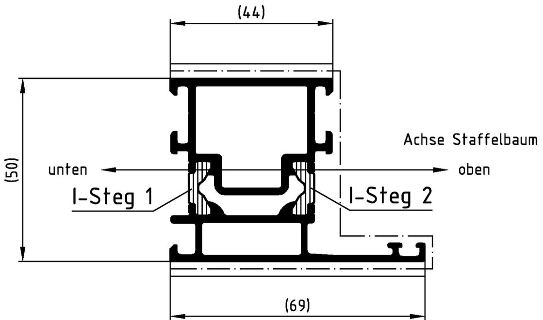
Die Profile sind generell in beiden Aluminium-Hohlkammern spannungsfrei aufzustaffeln.
