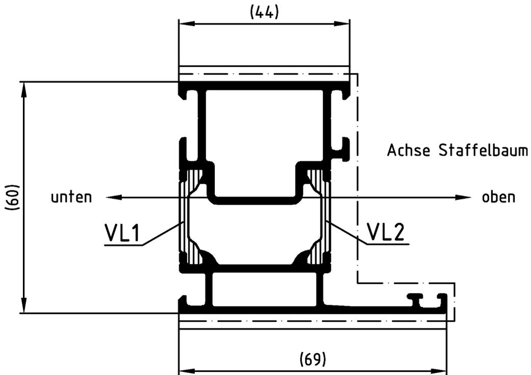
Die Profile sind generell in beiden Aluminium-Hohlkammern spannungsfrei aufzustaffeln.
