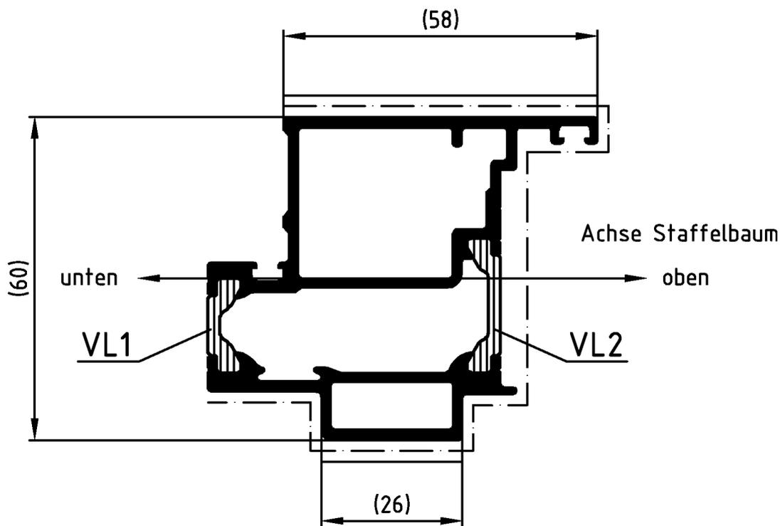
Die Profile sind generell in beiden Aluminium-Hohlkammern spannungsfrei aufzustaffeln.
