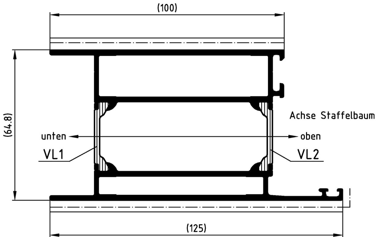
Profile vorzugsweise in einer Vertikalanlage beschichten.
