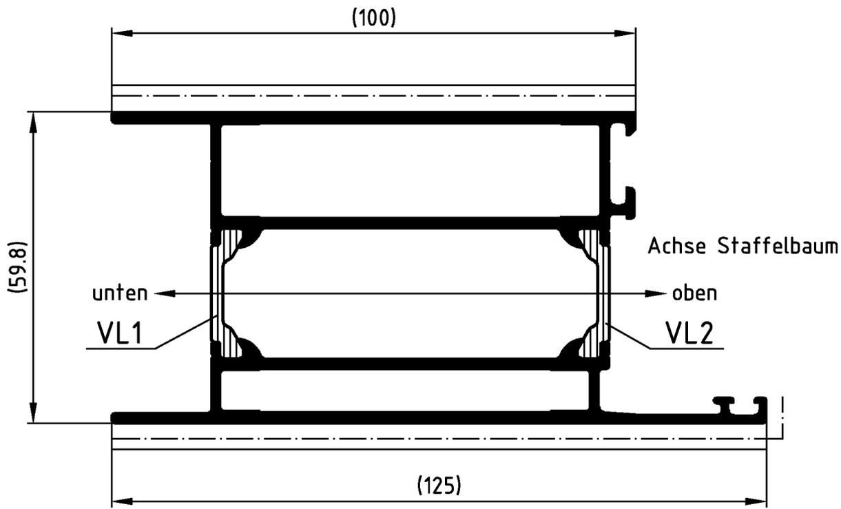
Profile vorzugsweise in einer Vertikalanlage beschichten.
