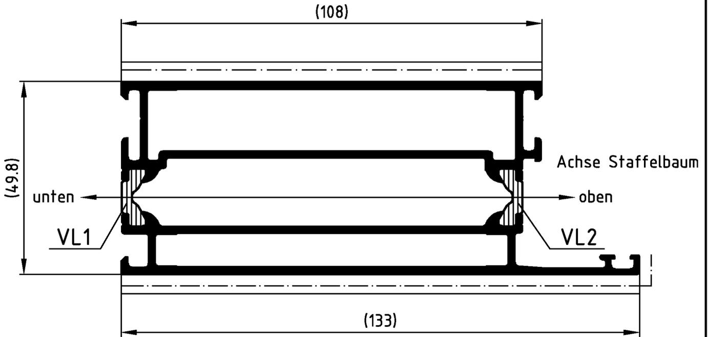
Die Profile sind generell in beiden Aluminium-Hohlkammern spannungsfrei aufzustaffeln.
