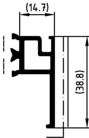
**ACHTUNG:** Nutenbereich (----) von Farbe, insbesondere von Farbspritzern und Verdickungen freihalten. Nicht vermeidbarer Lackauftrag im Nutenbereich maximal 20 µm.
