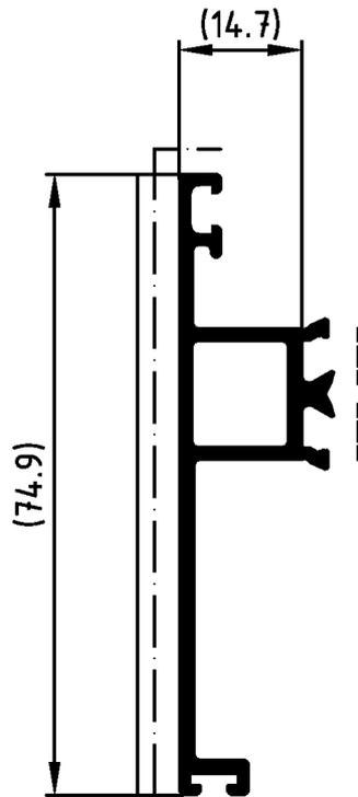
**ACHTUNG:** Nutenbereich (----) von Farbe, insbesondere von Farbspritzern und Verdickungen freihalten. Nicht vermeidbarer Lackauftrag im Nutenbereich maximal 20 µm.
