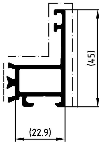
**ACHTUNG:** Nutenbereich (----) von Farbe, insbesondere von Farbspritzern und Verdickungen freihalten. Nicht vermeidbarer Lackauftrag im Nutenbereich maximal 20µm.
