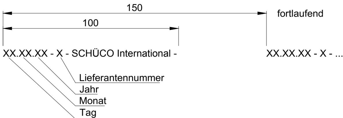
**Bemerkung:** Das Herstellungsdatum der Eloxaloberfläche ist zusätzlich zur Signierung auf die bemastete Profiloberfläche zu drucken.
