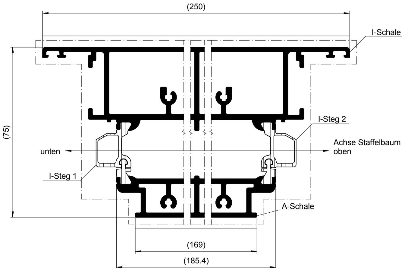
Beim Beschichten in einer Vertikalanlage ist eine Aufhängung über die Innen- und Außenschale zwingend erforderlich, um den Verbund gegen Verschub zu sichern.
