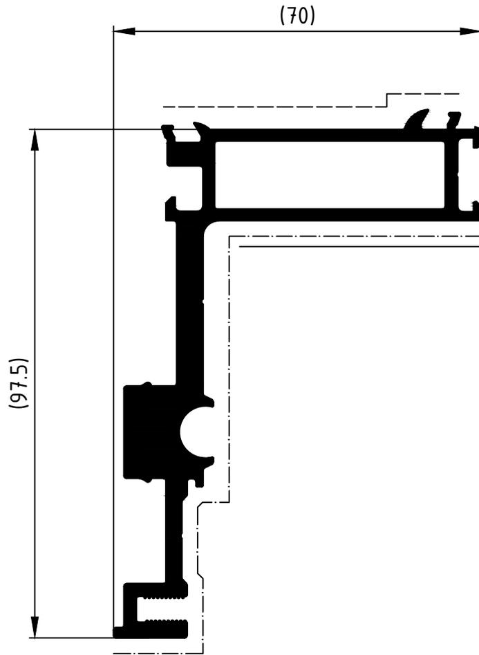
Achtung : Bereich (-----) von Farbe, insbesondere von Farbspritzern und Verdickungen freihalten. Nicht vermeidbarer Lackauftrag maximal 20 µm.
