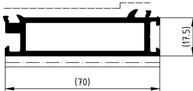
Achtung : Bereich (-----) von Farbe, insbesondere von Farbspritzern und Verdickungen freihalten. Nicht vermeidbarer Lackauftrag maximal 20 µm.
