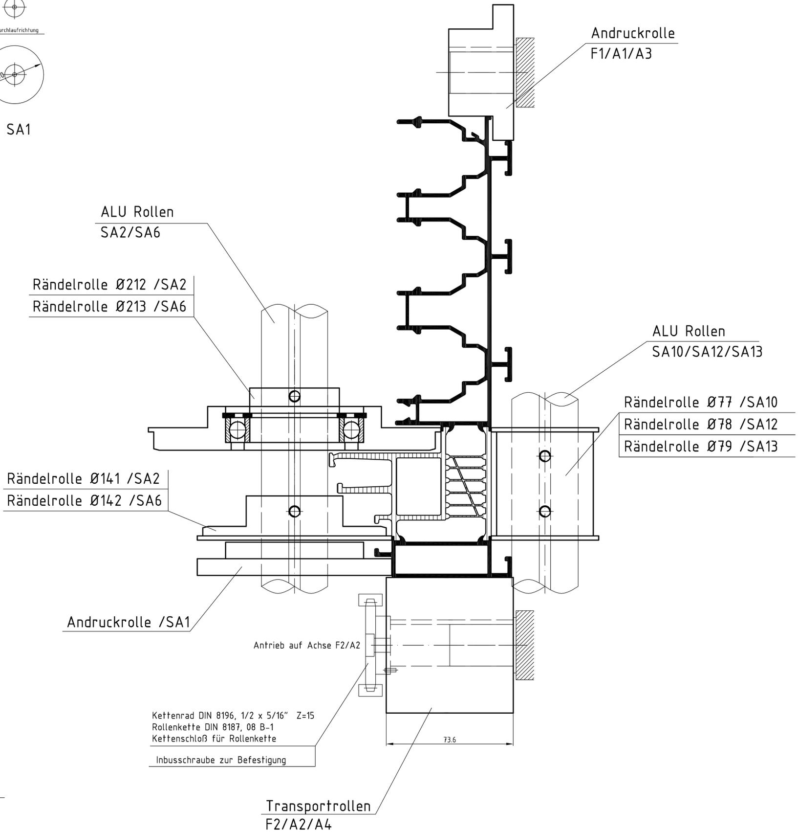
**Bestückungsfolge und Einrichtung des Rollensatz 283855 am Isomaten 4/5**
