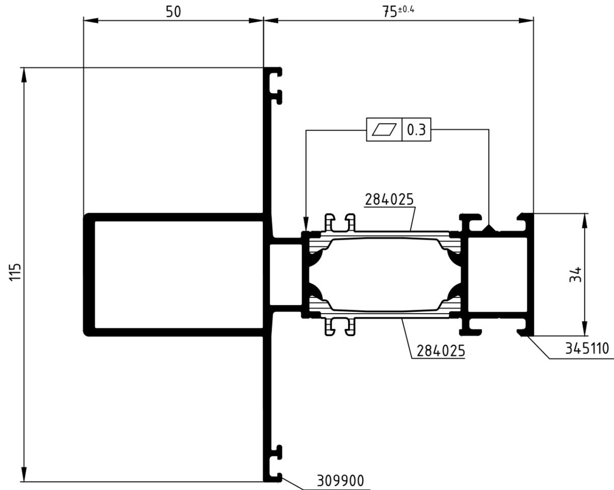
**Attention :** Le résultat du procédé de sertissage doit être vérifié sur la base des dimensions de référence dans ce plan de rouleaux. Veuillez noter les conseils de vérification dans le manuel actuel de rouleaux.
