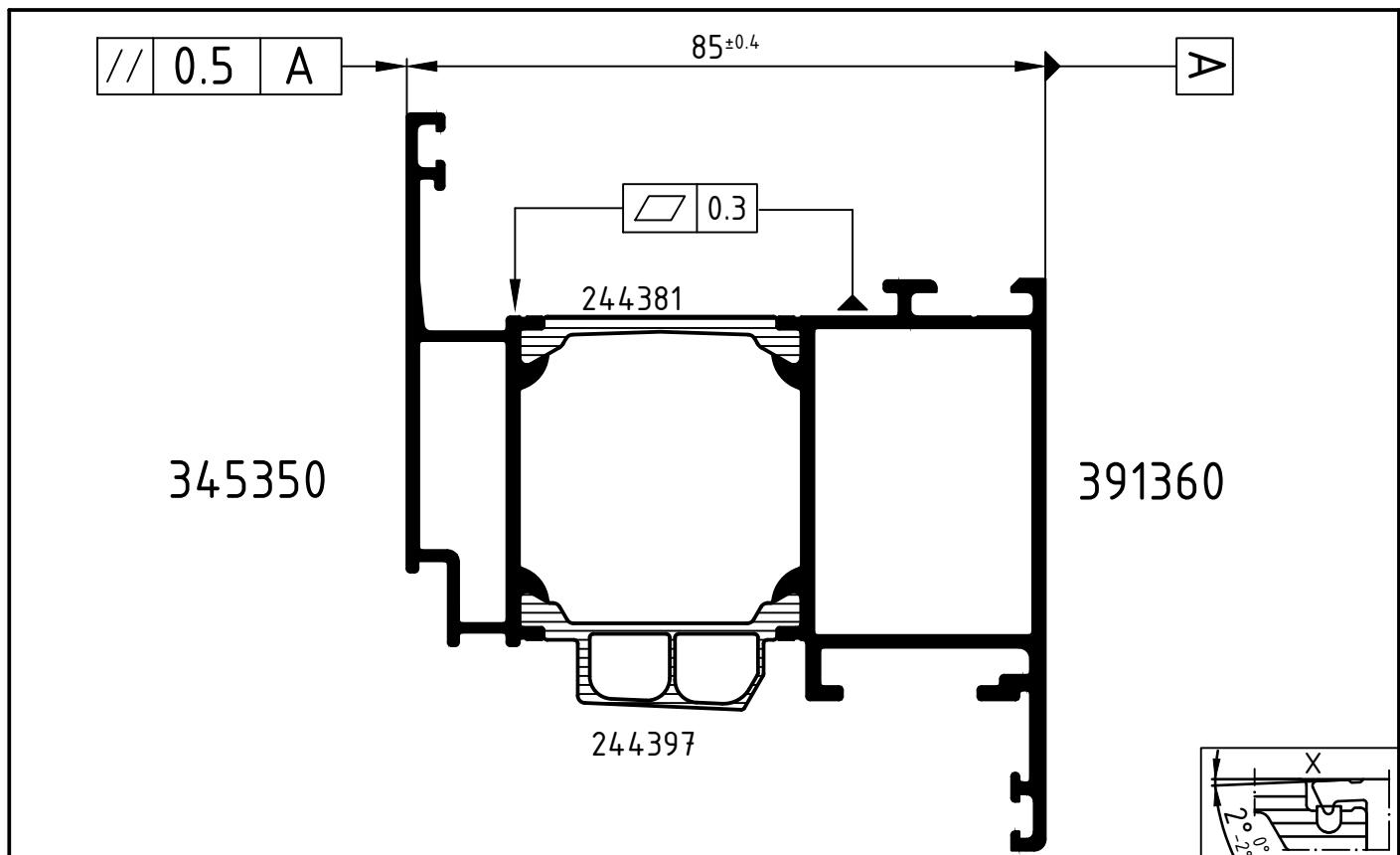
Attention : Das Rollergebnis ist nach dem Verbund des Profiles anhand der Prüfmaße im Rollenplan zu kontrollieren! Beachten Sie bitte auch die technischen Prüfhinweise im aktuellen Rollenhandbuch.
