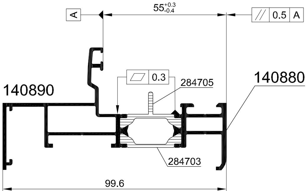
**Attention :** Le résultat du procédé de sertissage doit être vérifié sur la base des dimensions de référence dans ce plan de rouleaux. Veuillez noter les conseils de vérification dans le manuel actuel de rouleaux.
