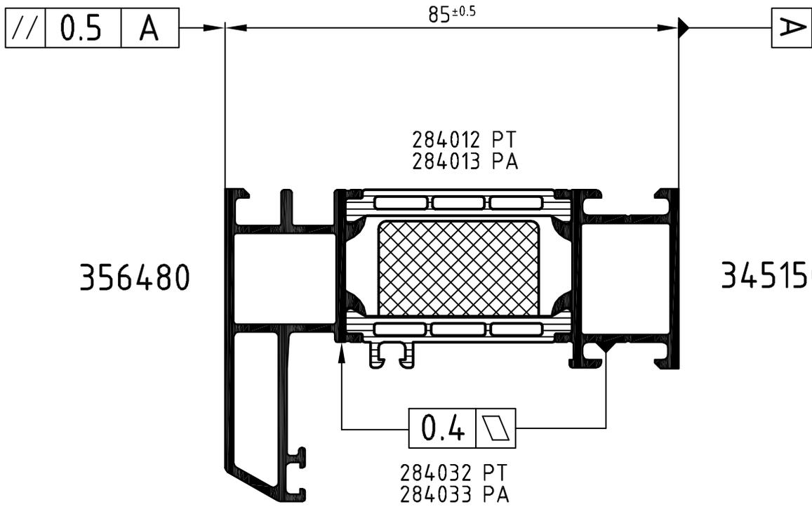
**Achtung:** Das Rollergebnis ist nach dem Verbund des Profiles anhand der Prüfmaße im Rollenplan zu kontrollieren!
