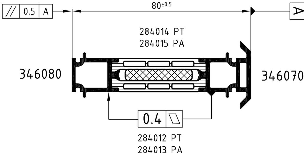
**Achtung:** Das Rollergebnis ist nach dem Verbund des Profiles anhand der Prüfmaße im Rollenplan zu kontrollieren!
