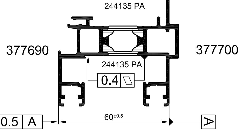
Attention : Le résultat du procédé de sertissage doit être vérifié sur la base des dimensions de référence dans ce plan de rouleaux. Veuillez noter les conseils de vérification dans le manuel actuel de rouleaux.
