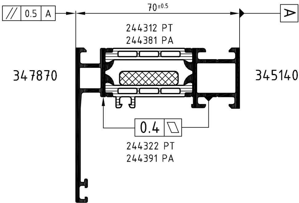
**Achtung:** Das Rollergebnis ist nach dem Verbund des Profiles anhand der Prüfmaße im Rollenplan zu kontrollieren!
