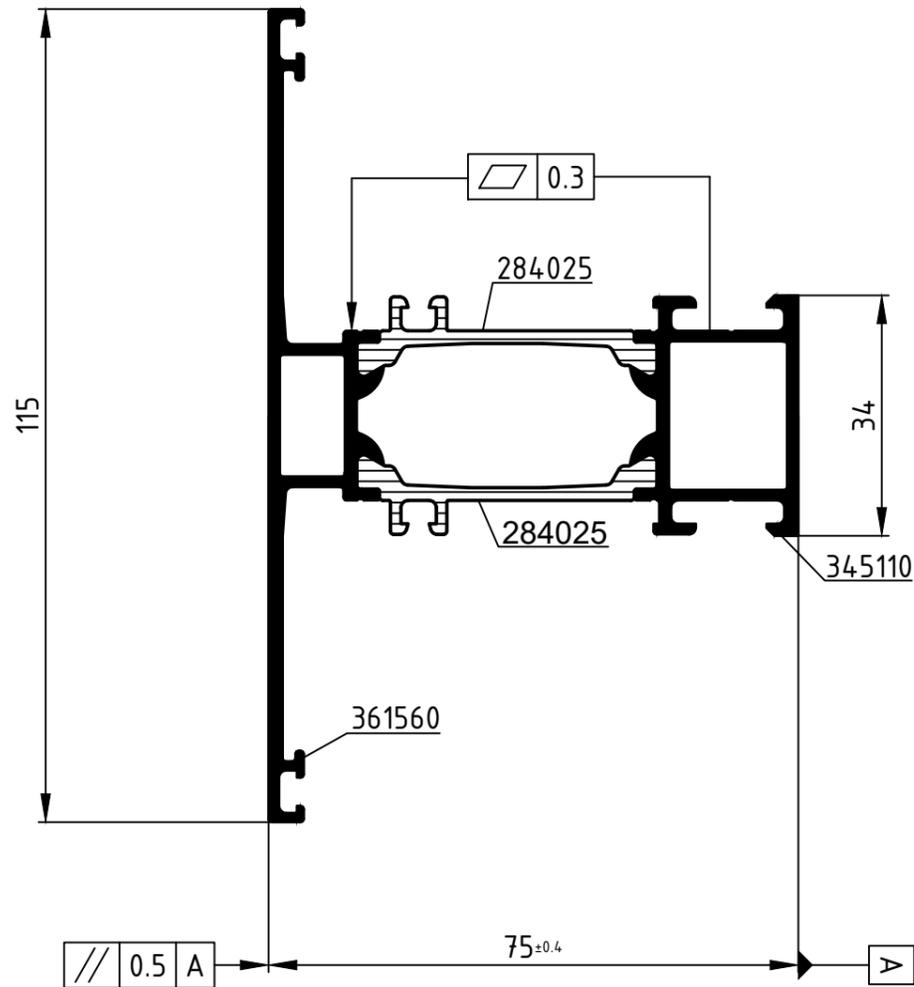
**Attention :** Le résultat du procédé de sertissage doit être vérifié sur la base des dimensions de référence dans ce plan de rouleaux. Veuillez noter les conseils de vérification dans le manuel actuel de rouleaux.
