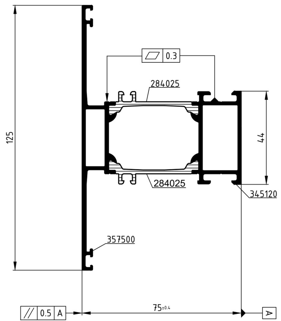
**Attention :** Le résultat du procédé de sertissage doit être vérifié sur la base des dimensions de référence dans ce plan de rouleaux. Veuillez noter les conseils de vérification dans le manuel actuel de rouleaux.
