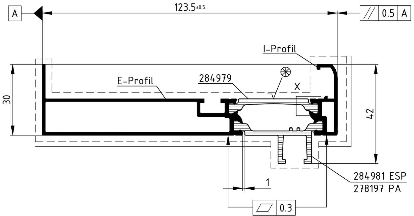
**Attention :** Le résultat du procédé de sertissage doit être vérifié sur la base des dimensions de référence dans ce plan de rouleaux. Veuillez noter les conseils de vérification dans le manuel actuel de rouleaux.
