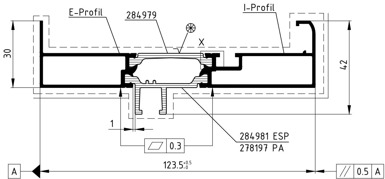
Attention : Le résultat du procédé de sertissage doit être vérifié sur la base des dimensions de référence dans ce plan de rouleaux. Veuillez noter les conseils de vérification dans le manuel actuel de rouleaux.
